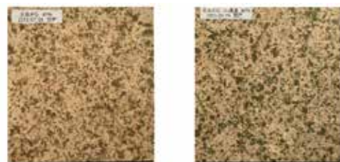
(b)茶がら配合ボード（製作後10ヶ月経過） 左写真：未処理、右写真：銅イオン処理
