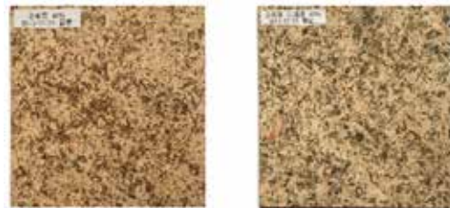
(a)茶葉配合ボード（製作後10ヶ月経過） 左写真：未処理、右写真：銅イオン処理
